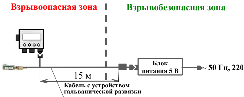
Рисунок 57 – Работа с корректором при питании от сети с помощью кабеля гальванической развязки РТЕХ.685611.064
