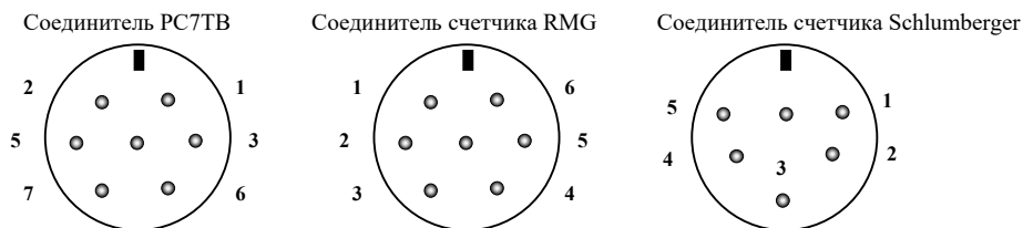
Рисунок 32 – Вид со стороны распайки ответного соединителя (соединителя счетчика газа)
