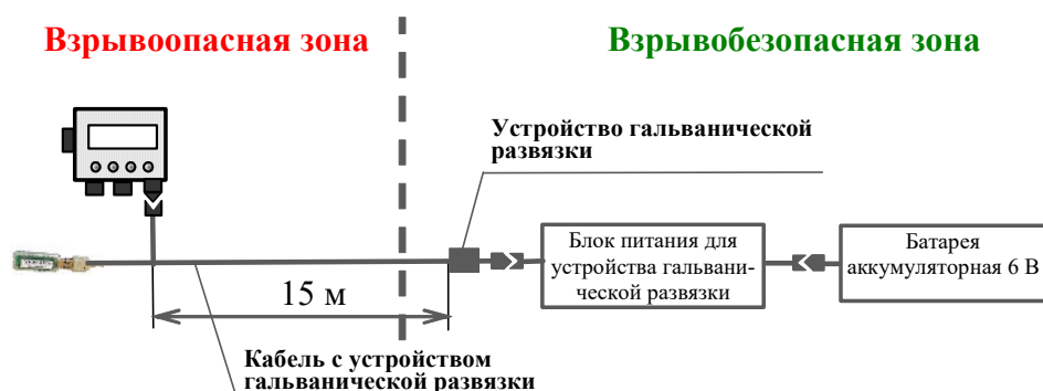
Рисунок 55 – Работа с корректором при питании от батареи аккумуляторной с помощью кабеля гальванической развязки РТЕХ.685611.064
