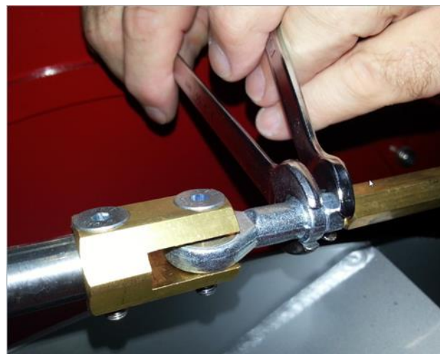
Fig. 51 для регулировки ослабить контргайку
