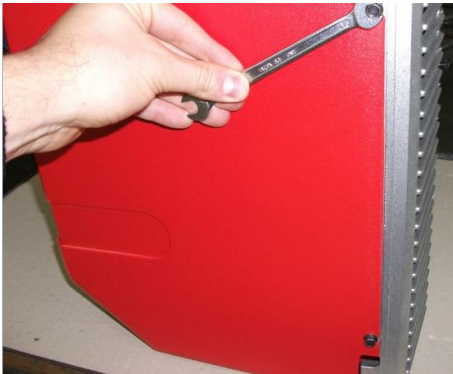
1) Снять кожух, ослабив 4 винта;
