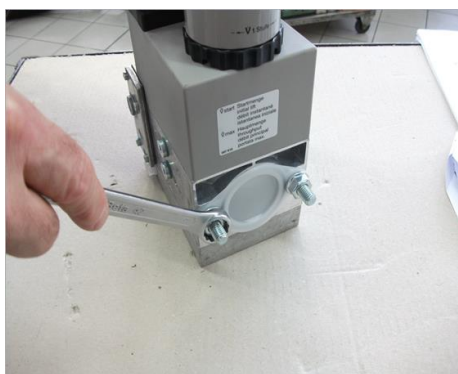
7) Снять заглушку из электроклапан;
