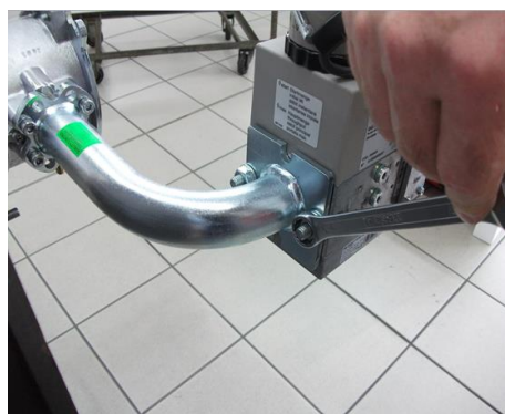
8) установить электроклапан и Прикрепить из фланец;
