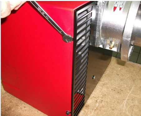
1) Снять кожух, ослабив 4 винта;
