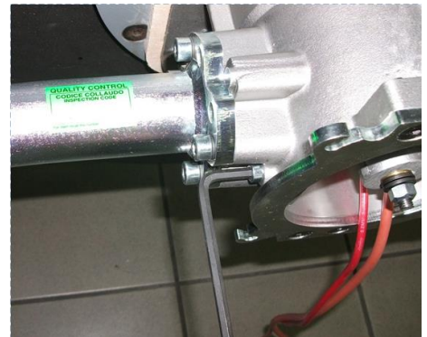
6) Отвинтить 2 винта см. рис.6-7;
