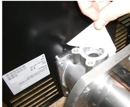
2) повернуть Горелка и Снять заглушку;
