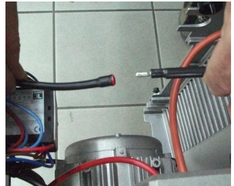
3) Отсоединить кабель электрода ионизации от разъема;
